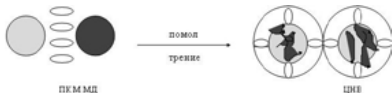
Рисунок 1 – Агрегация промежуточного продукта помола в комплексы
