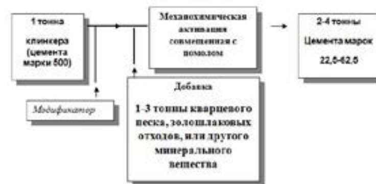
Рисунок 1 – Эффект механоактивации и нанокапсуляции, увеличение объемов производства цемента
