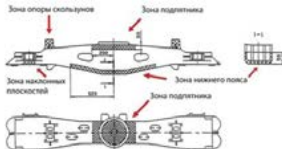
Рисунок 4 – Наддрессорная балка, зоны возможного возникновения дефектов
