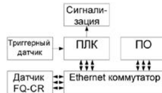
Рисунок 1 - Структурная схема системы контроля
