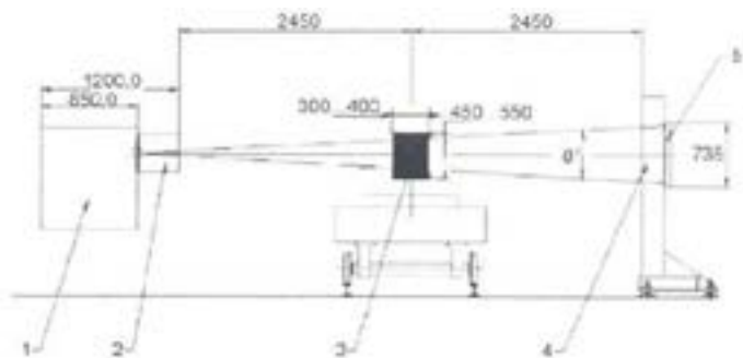
Рисунок 5 – Схема опытной интроскопической установки: 1 - ускоритель; 2 - первичный коллиматор; 3 - объект контроля; 4 - коллиматор; 5 - детекторная линейка
